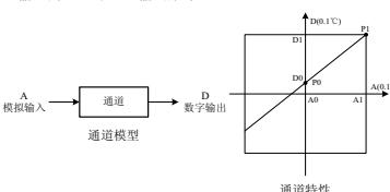
设置通道特性的目的是为了调整模块的现场线性误差，由于模块使用环境温度的不同及使用连接电缆的原因，会给测量结果带来误差，用户可以通过设置通道特性来消除此类误差。
