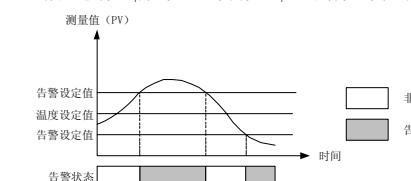
上限告警和下限告警忽略电源接通时的测量值触发的告警；
